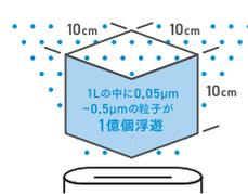
ミスト量は、一般的な加湿器の約1,000倍。1L中に、約1億個のウルトラマイクロミストが発生しています。広さ180 $\text{m}^2$ の空間に約4分で拡散し、ミストは均一に浮遊します。さらに、長時間浮遊することができます。angstrom の置く位置に影響がなく、均一な加湿ができます。
