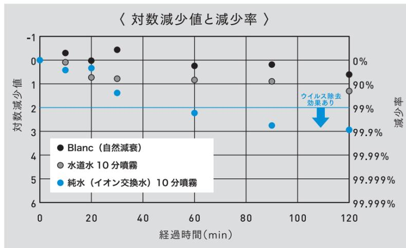
2023年に試験を行った結果、純水をウルトラマイクロミストにして噴霧することでウイルスが99.9%減少することを確認しました。安全が担保された純水は、人に優しいだけでなくホワイトダスト(炭酸カルシウム)の発生を極限まで抑制し、清潔な空間を作り出してくれます。
