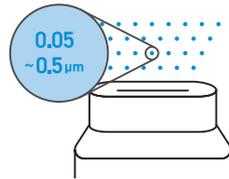
粒子径 0.05~0.5 $\mu$ m のウルトラマイクロミストは、ブラウン運動という物理現象により、送風力と関係なく、ミストの特性で、広い空間に素早く拡散し、長時間浮遊します。一般的な加湿器の約1/100の大きさです。
